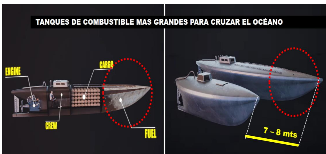
Figura 4. Comparación entre semisumergibles interoceánicos y los corrientes.
