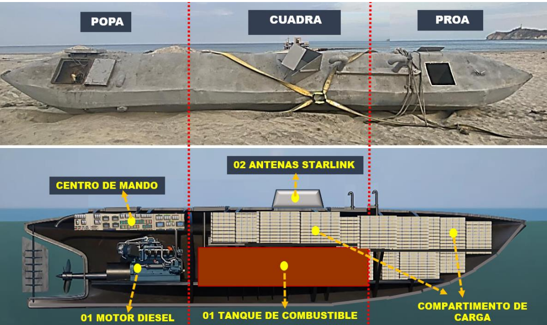
Figura 12. VSA decomisado en Colombia (2025). Fuente: Foto Armada de Colombia, bosquejo elaboración propia
