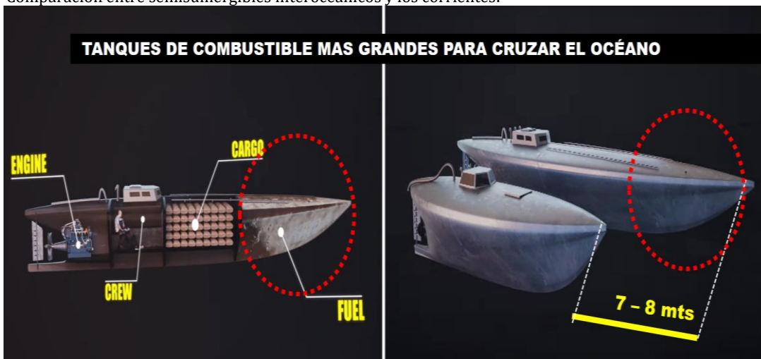
Figura 4. Comparación entre semisumergibles interoceánicos y los corrientes.
